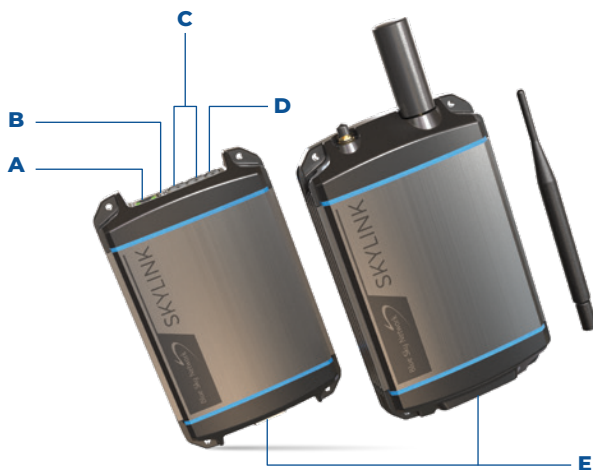
Gateway de dados "dual mode" mostrado com opcionais de comunicações e antena extensora LTE.
